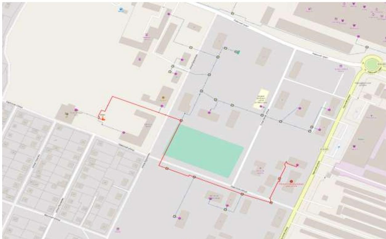
Рисунок 31 - Путь теплоносителя по направлению от котельной № 10 до здания по ул. Арычная, 27
