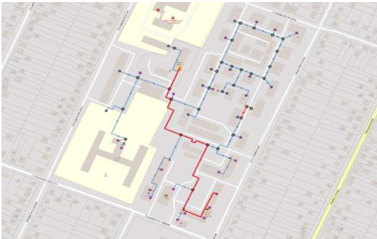
Рисунок 25 - Путь теплоносителя по направлению от котельной № 6 до здания по ул. Ломоносова, 82
