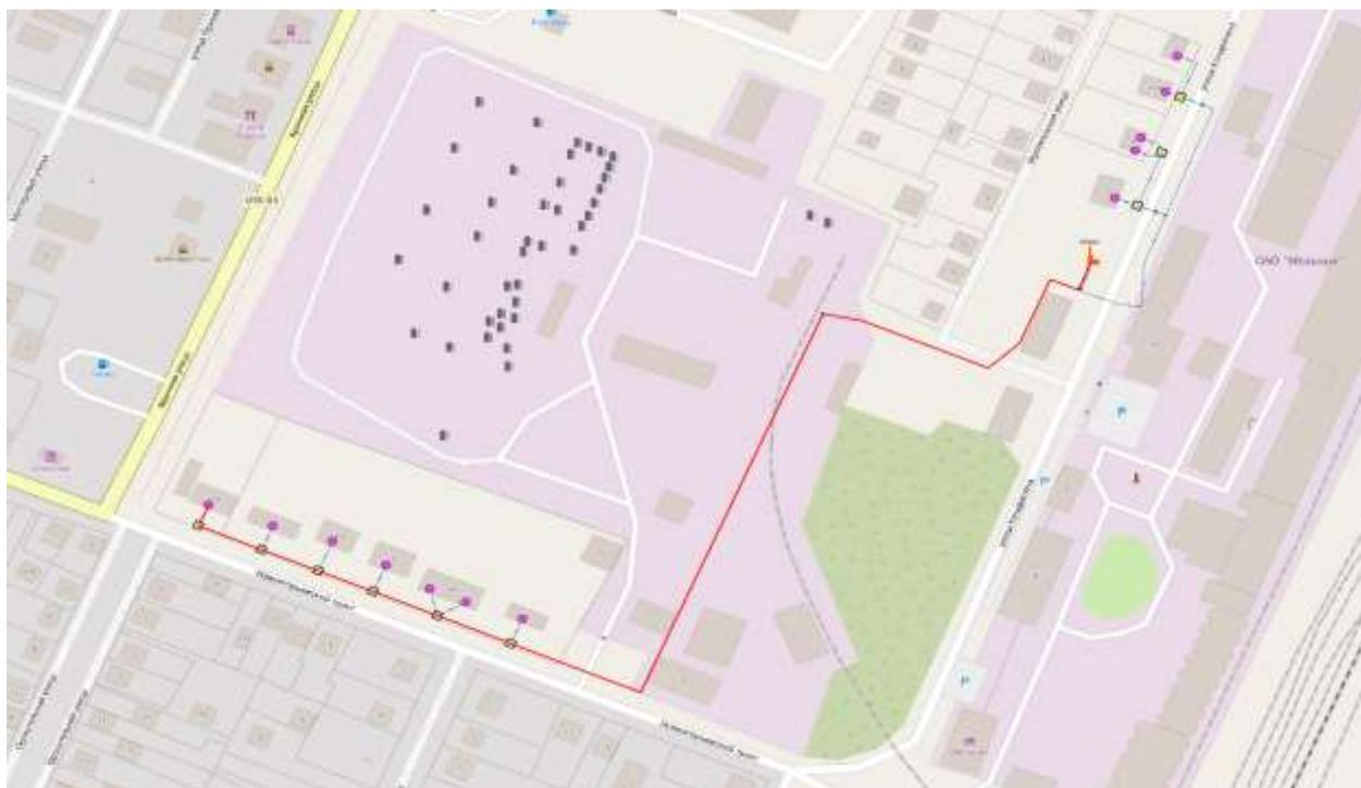
Рисунок 33 - Путь теплоносителя по направлению от котельной № 11 до здания по Новогорьевскому тракту, 12а
