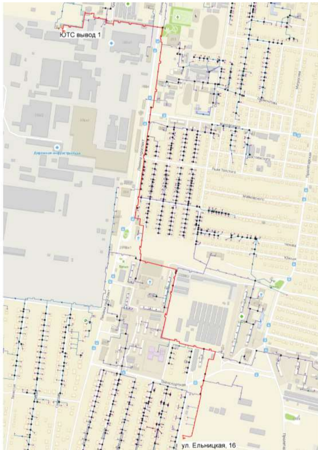
Рисунок 5 - Путь теплоносителя по направлению от ЮТС, вывод № 1 до индивидуального жилого дома по ул. Ельницкая, 16
