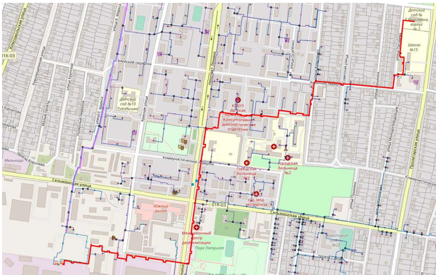
Рисунок 1 - Путь теплоносителя по направлению от ЮТС, вывод № 1 до здания по ул. Пролетарская, 284г
