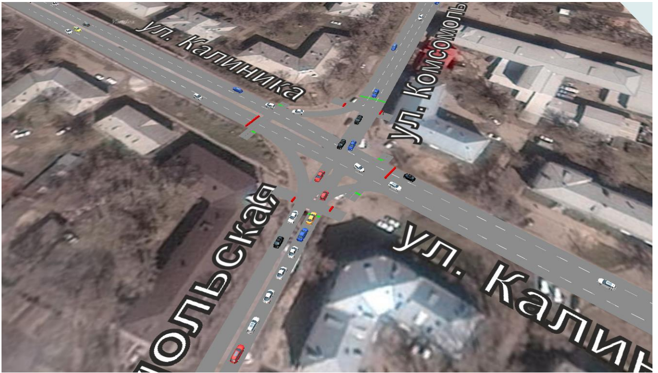
Рисунок 10 – Симуляция транспортных потоков в PTV Vision Vissim
