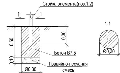
Схема установки газонного ограждения (3).
